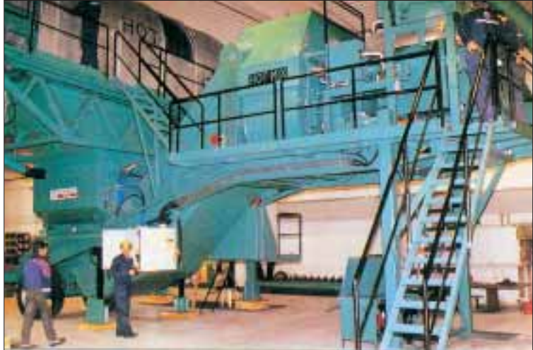
Hot Mix -kuumamassa-asema valmiina tehtaalla.
