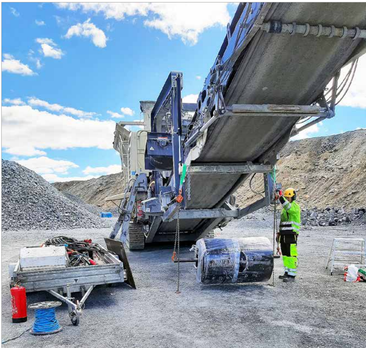
Iin Hihna ja Teollisuuspalvelu Oy:n palveluita tarvitaan muun muassa Kevitsan kaivoksella. Kuvassa mobiilimurskan hihnan asennus käynnissä.
