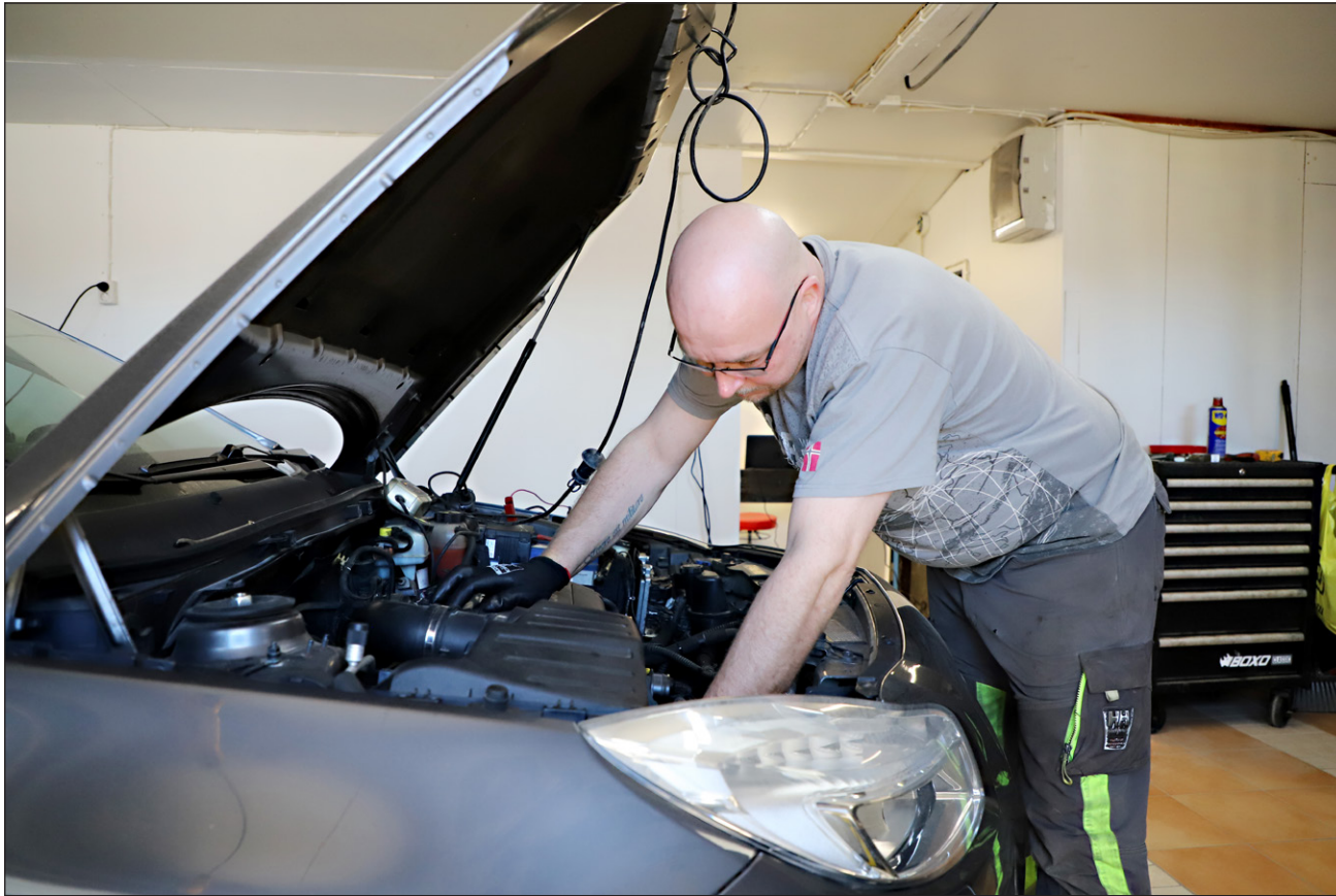
Marko Luttinen vaihtaa tähän Opeliiin uuden laturin.
