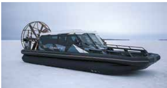
Hydrokoptern, en flatbottenad båt som drivs av en luftpropeller ovanför vattenytan. Bild: West Coast Rib Charter
