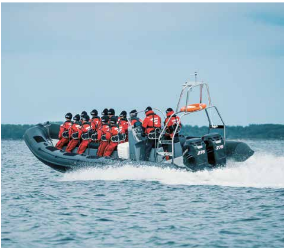
Båten, en Parcer Baltic 900. Nio meter lång och drygt tre meter bred. Utrustad med dubbla 275 hästkrafters motorer. En RIB är en hybrid av en vanlig båt och en gummibåt. Bild: West Coast Rib Charter
