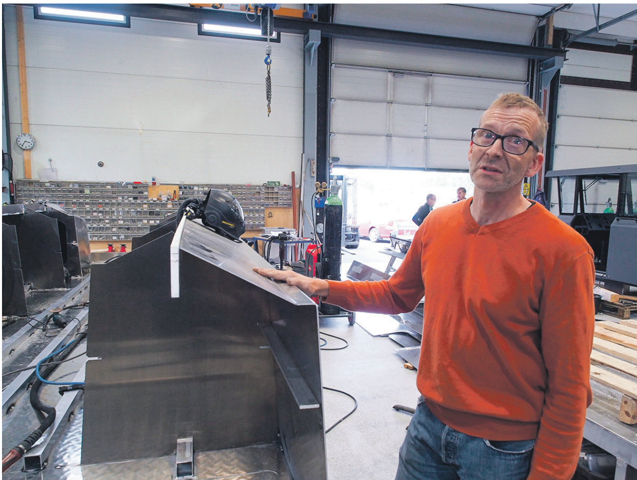
Tomi Arvo näyttää, miten MAX-veeneen alumiiniset tuplarungot hitsautuvat kasaan. Vahva alumiiniköli tuo suojaa rantautumisessa.
